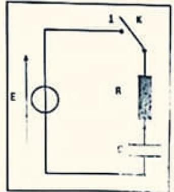
**Q31:** Le prof demande à l'un de ses élèves d'écrire au tableau les équations différentielles vérifiées par les grandeurs électriques du circuit ( $q$ ,  $i$ ,  $u_R$  et  $u_C$ ) quand l'interrupteur est mis en position (1). L'élève a écrit les quatre équations qui suivent. Seule l'une d'entre elles ne comporte pas d'erreurs, laquelle? Cocher la bonne réponse :
