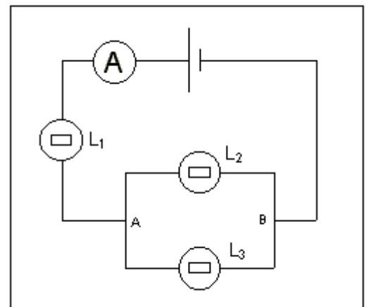
2- Déterminer les courants circulant dans les lampes  $L_1$  ;  $L_2$  et  $L_3$ .
