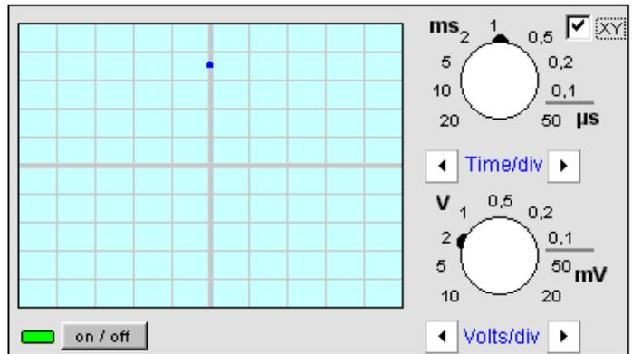
L'oscilloscope est en mode XY. Le balayage n'est pas en fonction.
