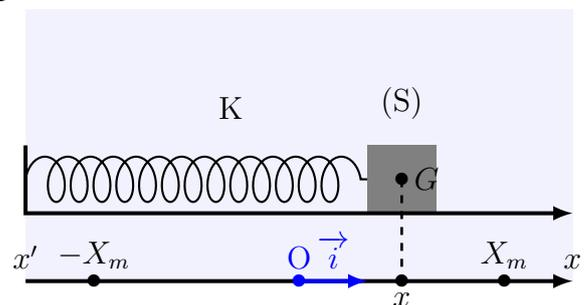
On considère un axe  $(O, \vec{i})$ , avec O coïncide avec la position du centre d'inertie G du solide à l'équilibre et le vecteur unitaire  $\vec{i}$  parallèle au déplacement du solide.
