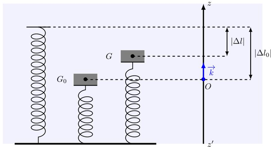
Le repérage des positions  $z$  du centre d'inertie  $G$  du solide se fait selon un axe  $Oz$  orienté vers le haut; l'origine  $O$  est choisie à la position d'équilibre  $G_0$  du centre d'inertie du solide.
