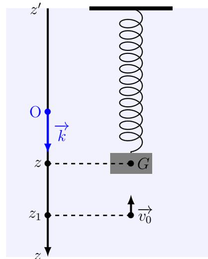
1. Montrer que le mouvement du centre d'inertie  $G$  du solide obéit, en absence de frottement, à l'équation différentielle suivante :
