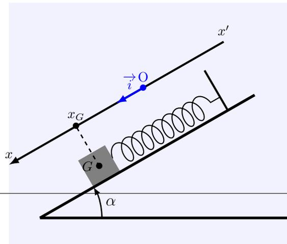
1. Le ressort de longueur  $l_0 = 20\text{cm}$  au repos , à l'équilibre la longueur du ressort est  $l = 25\text{cm}$  . En déduire la valeur de la constante de raideur  $K$  du ressort . On prend  $g = 10\text{m/s}^2$
