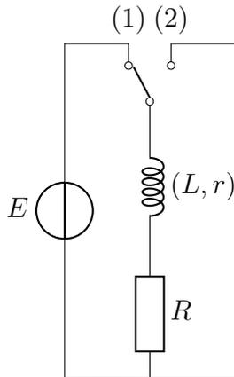
À chaque période  $T/2$  on met l'interrupteur en une position, tel que en (1) on parle de l'établissement du courant, alors en (2) de la rupture de ce dernier.
